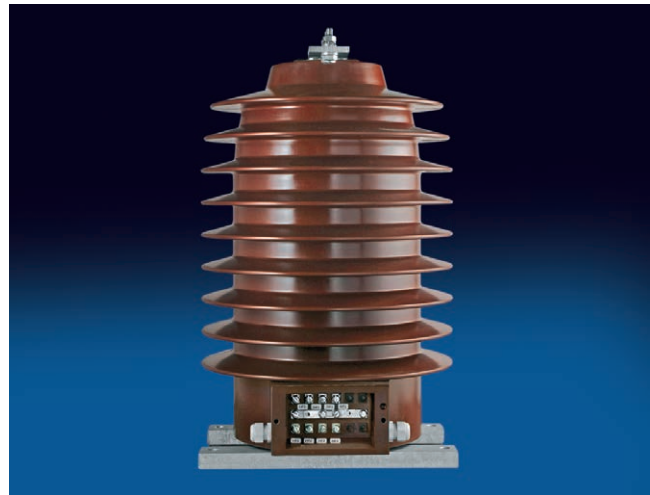
Transformateur de tension pour application extérieure avec ailettes caractéristiques pour l'allongement de la ligne de fuite.
